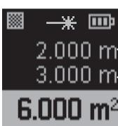
Nach Abschluss der zweiten Messung wird die Fläche automatisch errechnet und angezeigt. Das Ergebnis wird in der Ergebniszeile **(f)** angezeigt. Die Einzelmesswerte stehen in den Messwertzeilen **(e)**.
