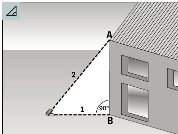
Mit der Messfunktion **Indirekte Höhe** können Sie die Strecke **AB** ermitteln, indem Sie die Strecke **1** und **2** messen. Das Messwerkzeug errechnet die gesuchte Höhe **AB** aus den Strecken **1** und **2**.
