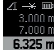
Nach Abschluss der Messung wird die Höhe automatisch errechnet und in der Ergebniszeile **(f)** angezeigt. Die Messwerte für die Strecke **1** und **2** stehen in den Messwertzeilen **(e)**.
