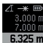
Depois de concluirda a medição, a altura é automaticamente calculada e indicada na linha de resultados **(f)**. Os valores de medição para o trajeto **1** e **2** encontram-se nas linhas do valor de medição **(e)**.
