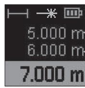
Em caso de várias medições de comprimentos sucessivas, os resultados das últimas medições são exibidos nas linhas dos valores de medição (e). O último valor de medição (e) é exibido em baixo no display, o penúltimo, acima desse etc.
