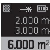
Depois de concluirda a segunda medição, a área é automaticamente calculada e indicada. O resultado é indicado na linha de resultados **(f)**. Os valores de medição individuais encontram-se nas linhas do valor de medição **(e)**.
