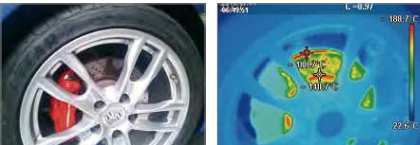
測試運作後的 4 輪煞車溫度
