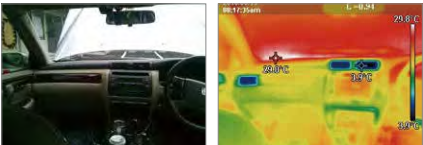
從吹風口吹出的冷氣溫度
