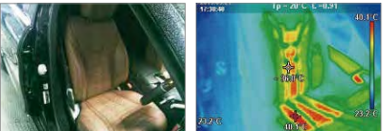
確認加熱墊表面的溫度變化
