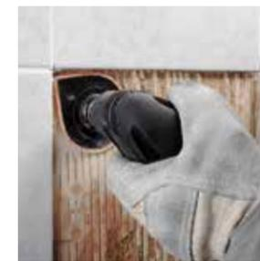
移除頑強的灰泥或磁磚黏著劑，例如：更換破損磁磚
