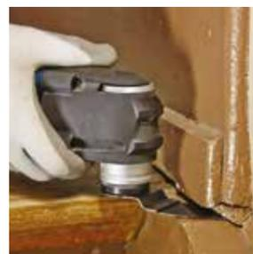
難以施工位置的拼花地板砂磨，例如：狹小凹陷處
