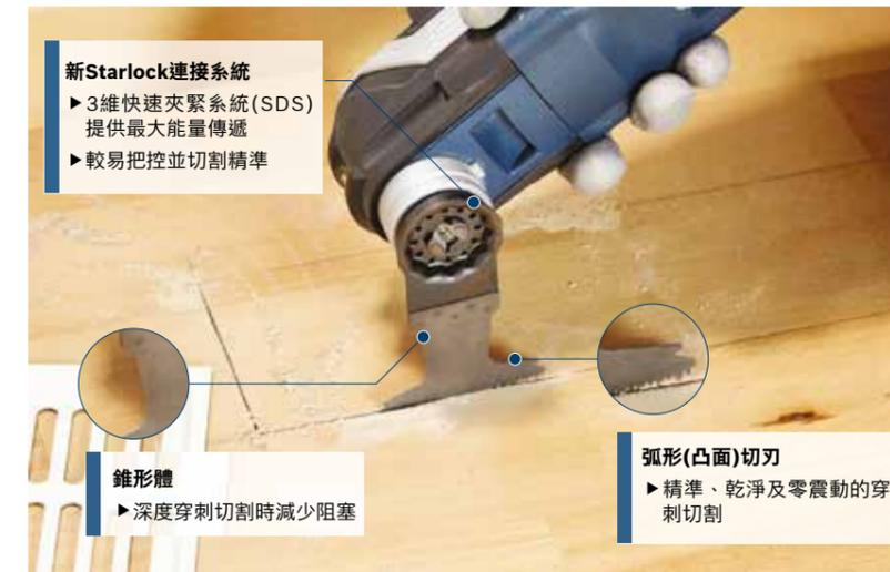
弧形（凸面）切刃結合新Starlock系統與錐形體—此獨一無二的技術為木材、硬木與木材／金屬用途提供最精準的穿刺鋸片。新Curved-Tec精準弧形切刃穿刺鋸片能使您執行精準、控制良好、零震動且平順的穿刺切割。相較於傳統直進切刃，弧形鋸齒不易磨損，因此使用壽命更長。
