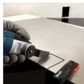
可使用BiM-TiN切割片或碳化鎢穿孔切割鋸片（inox）切割金屬板—不產生過多飛濺火星
