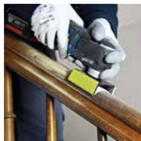
使用弧形磨盤快速平穩砂磨圓形表面，例如最大直徑55 mm的樓梯扶手
