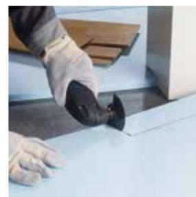
乾淨快速切割特定大小的吸音板、橡膠墊、地毯等
