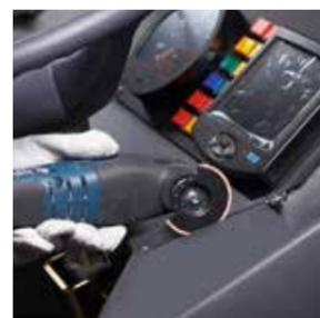
薄切口碳化鎢RIFF切割片（超薄切口）特別適合切割/擊碎磨削材質的汽車或船舶零件，例如儀表板凹槽
