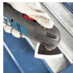
使用砂紙和研磨盤進行砂磨、移除和拋光亮漆。
