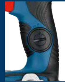
▶ 決定自行購買可藍牙連接的博世電動工具，並通過GCY 42 模組、可以擴展工具的功能和相關設定的可能性
